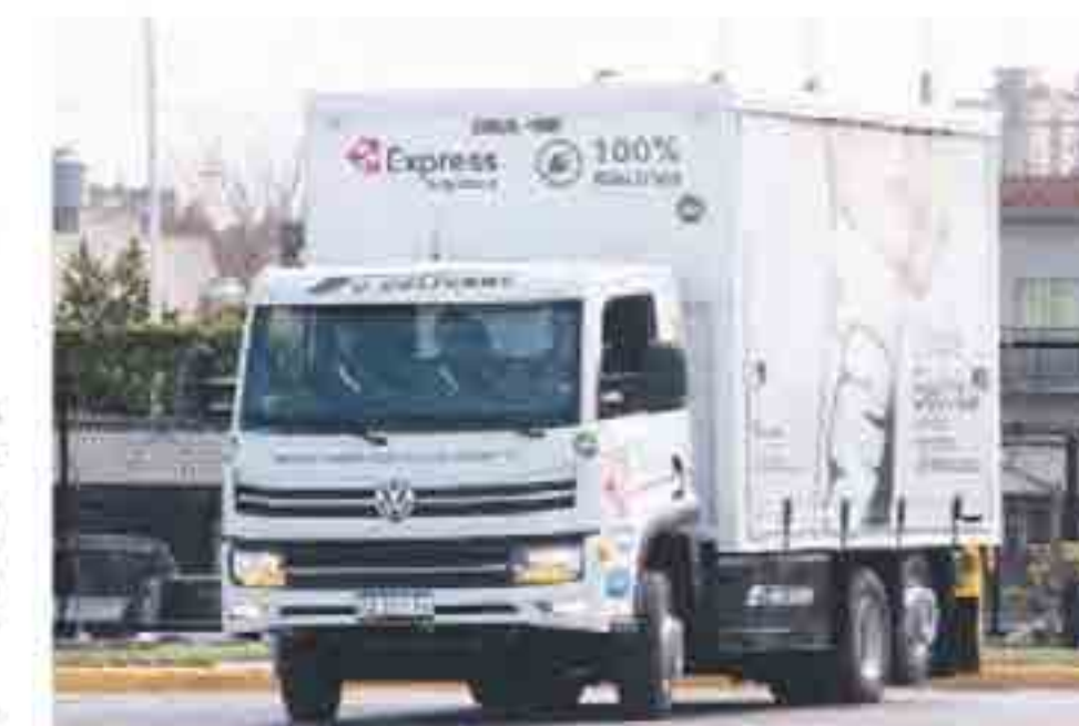
MODELO. El camión VW e-Delivery tiene una autonomía de 250 km.
